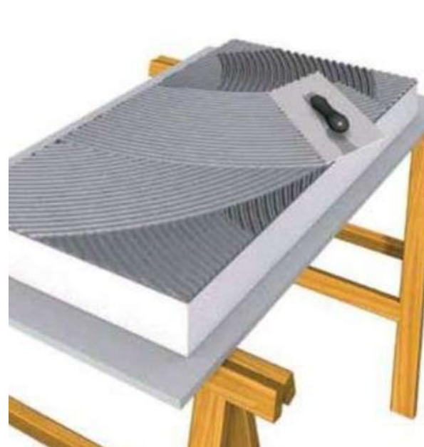
Incollaggio «a tutta superficie» (obbligatoria su supporti in legno o fibrocemento o negli intradossi orizzontali dei solai piani)
